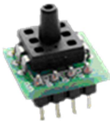
型号 XMP07 PCB 尺寸 12 * 13.5mm 芯体 SOP6 封装
