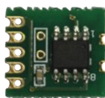
型号 XMP02 方形 PCB 尺寸 11.6*13.6mm
