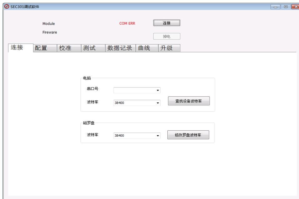
可通过此界面修改模块波特率，查询模块波特率，选择串口号。
