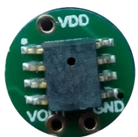
型号 XMP00 PCB 直径 10mm
